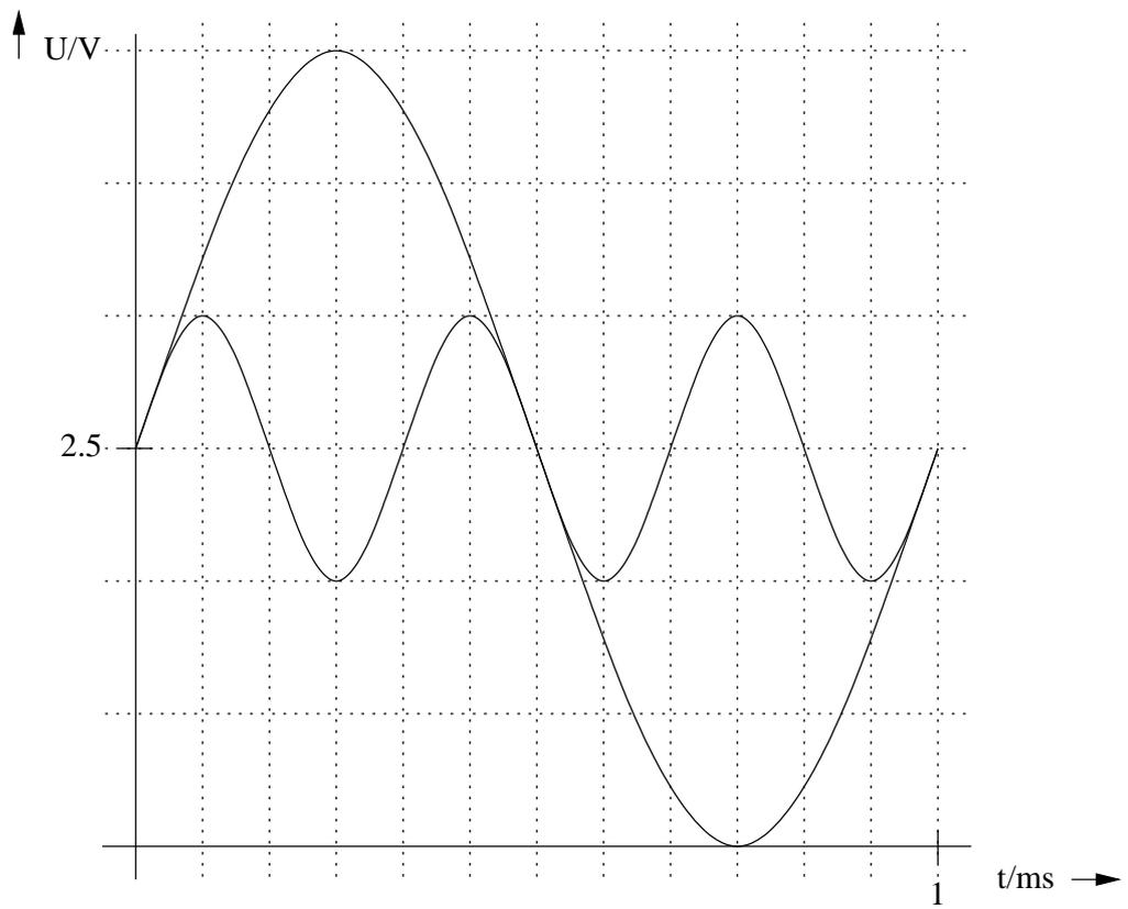
Abbildung 2: Übung zur Addition von Grundwelle und erster Oberwelle
