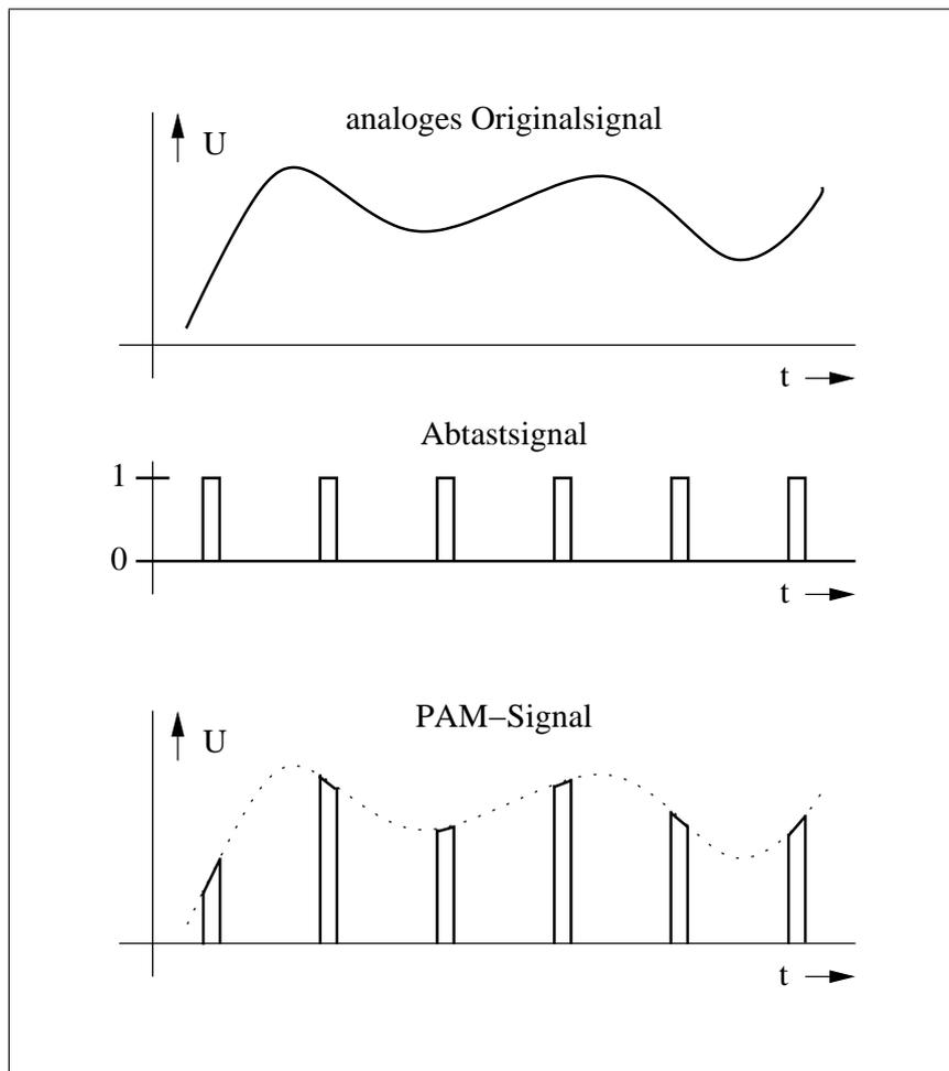
Abbildung 7: Puls-Amplituden-Modulation
