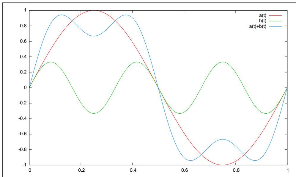
Abbildung 3: Fourierreihe der Rechteckfunktion mit `gnuplot` gezeichnet
