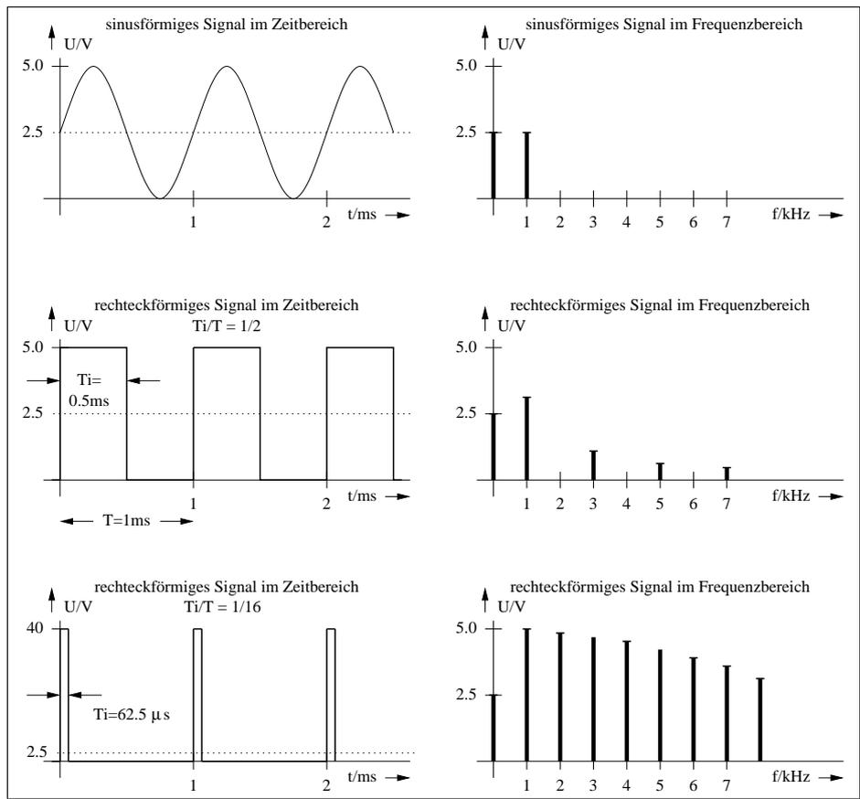
Abbildung 5: Frequenzspektrum der Sinus- und Rechteckschwingung
