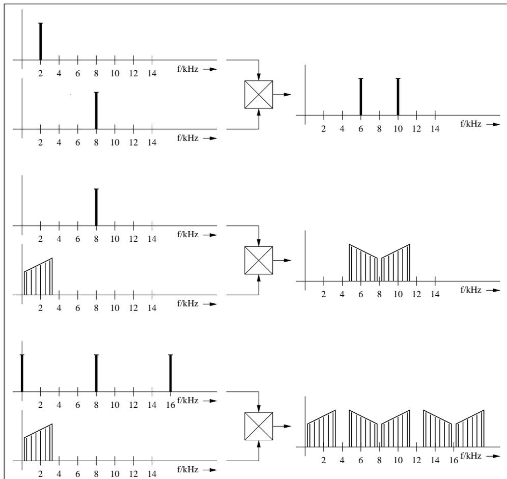
Abbildung 8: Multiplikation von Signalen bei der Abtastung (PAM)
