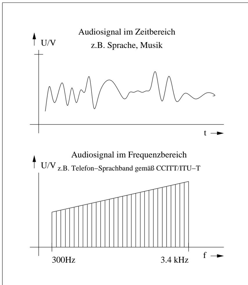
Abbildung 6: Das Telefonsignal im Zeit- und Frequenzbereich
