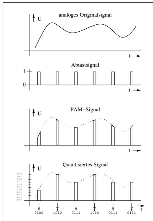
Abbildung 1: Abtastung und Digitalisierung eines Analogsignals
