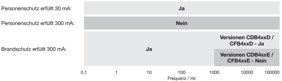
Erfüllung Personen- und Brandschutz RCD Typ B in Abhängigkeit der Frequenz
