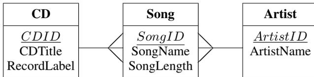
Abbildung 3: Entity-Relationship-Blockdiagramm
